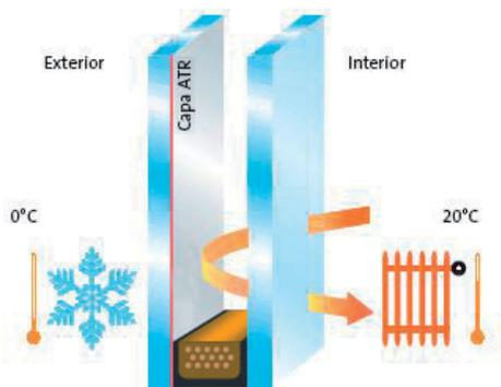
El CTE marca unos valores mínimos de transmitancia térmica “U” y factor solar “g” según la zona. Con estos mínimos, se han diseñado acristalamientos que proporcionan esos valores de “U” y de “g”. La comparación entre éstos y los proporcionados por las soluciones de acristalamiento propuestas, permiten obtener en porcentaje las reducciones de consumo energético que aquí presentamos.
